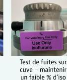
Fuite au niveau de la cuve anesthésique, concerne le plus souvent la zone de remplissage. · Vérifier le joint
